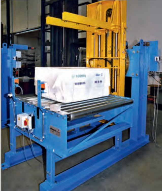
Drehvorrichtung zum Entgraten von Gussteilen mittels Industrieroboter
