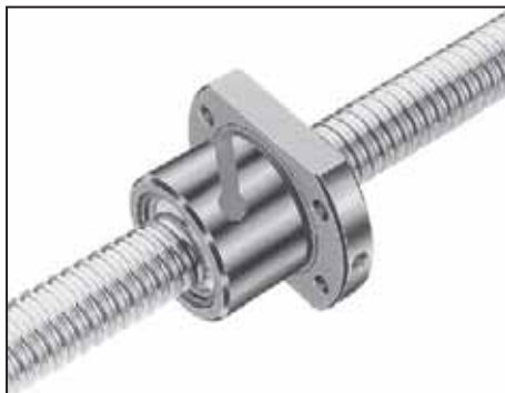
Flänsmutter typ U med cirkulationsrör i mutterdiametern samt smörjhål.
