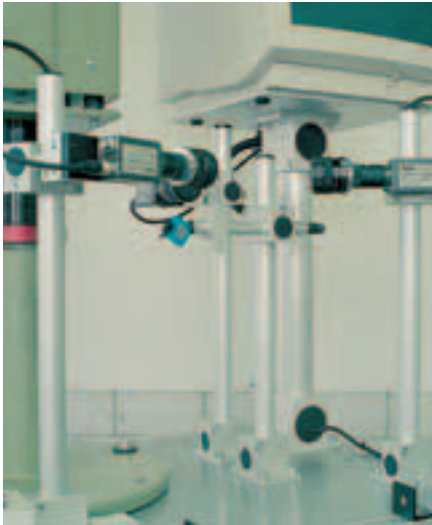
Anordning för att hålla optisk testutrustning
