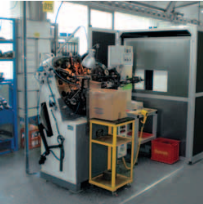
Ljudisolering på räls för öppning och stängning
