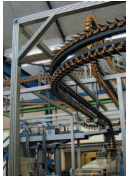
Transportanläggning för tidningspapper
