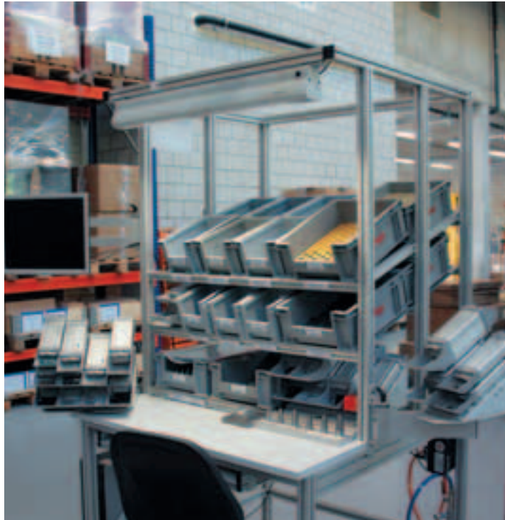
Arbetsplats för montering
