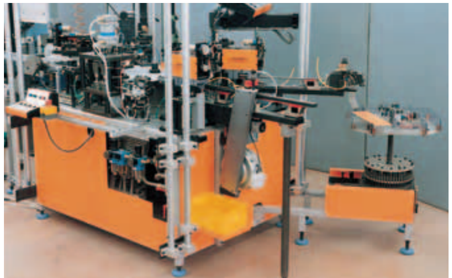
Styrning till skyddsöverdrag för automatisk monteringsmaskin med motviker i aluminiumrören.
