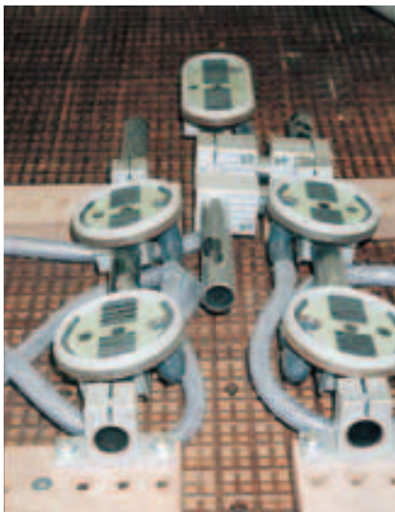
Stativ till vakuumutrustning för test av stolsryggar.
