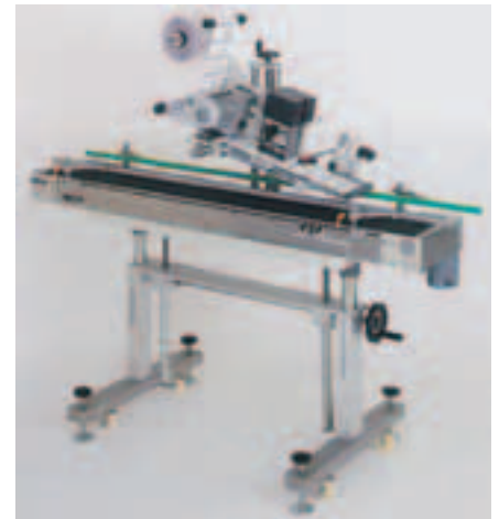
Märkningsmaskin med svängarm för limning.
