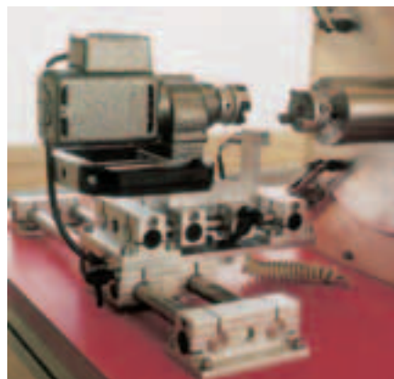
I och urkopplingsbar motor på en X / Y justerbar enhet för en mikrobeläggning. Elmotorn är i frikopplat läge.
